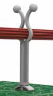
Untere Bohrung: Schnappbefestigung Ø 4 ± 0.08 Materialstärke: 0.8-2
